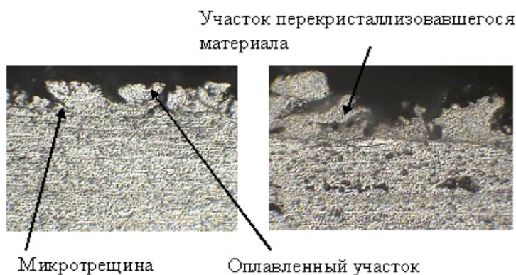
Рис. 6. Микроструктура мишени в образце № 4, увеличение  $\times 1000$
