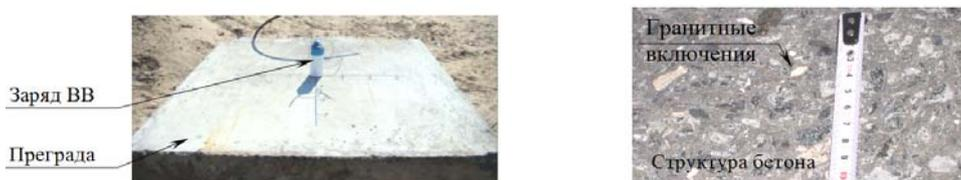
Рис. 2. Вид бетонной преграды
