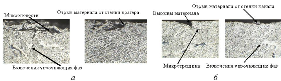
Рис. 4. Микроструктура образцов при скорости соударения 250 м/с: а – образец №1, увеличение x1000; б – образец №2, увеличение x1000
