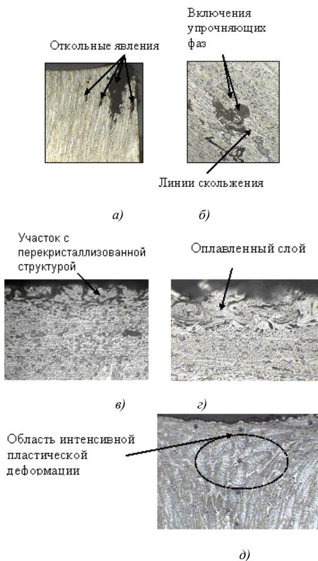
Рис. 5. Макроструктура образца №3: а – увеличение x25; б – увеличение x800; в – увеличение x1000; г – увеличение x1000; д – под донной частью кратера, увеличение x100
