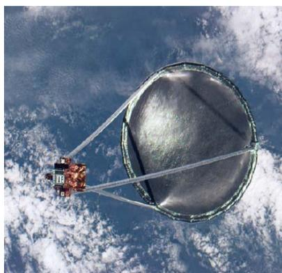
Рис. 1. Антенна, разработанная компанией L'Garde. Летный образец в космосе (рабочее положение)
