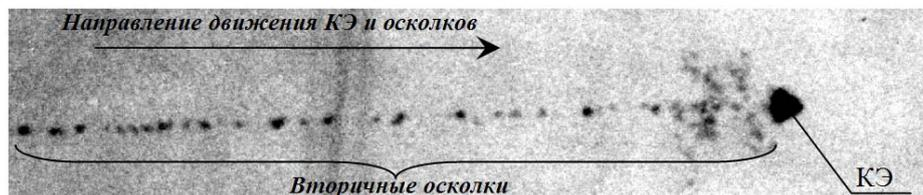
Рис. 2. Типичная рентгенограмма элемента, формируемого КМУ
