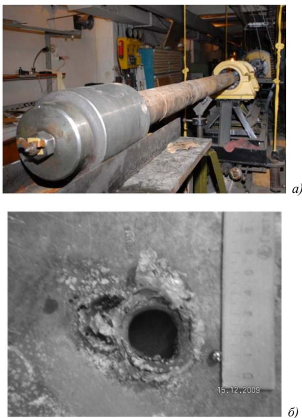
Рис. 1. Экспериментальный стенд для проведения физического эксперимента (а) и лицевая сторона преграды (б) после взаимодействия со сферическим ударником при скорости  $V_0 = 5500$  м/с
